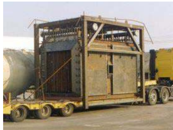
Котел для рекуперации тепла известеобжигательной печи, на пути до места монтажа.
